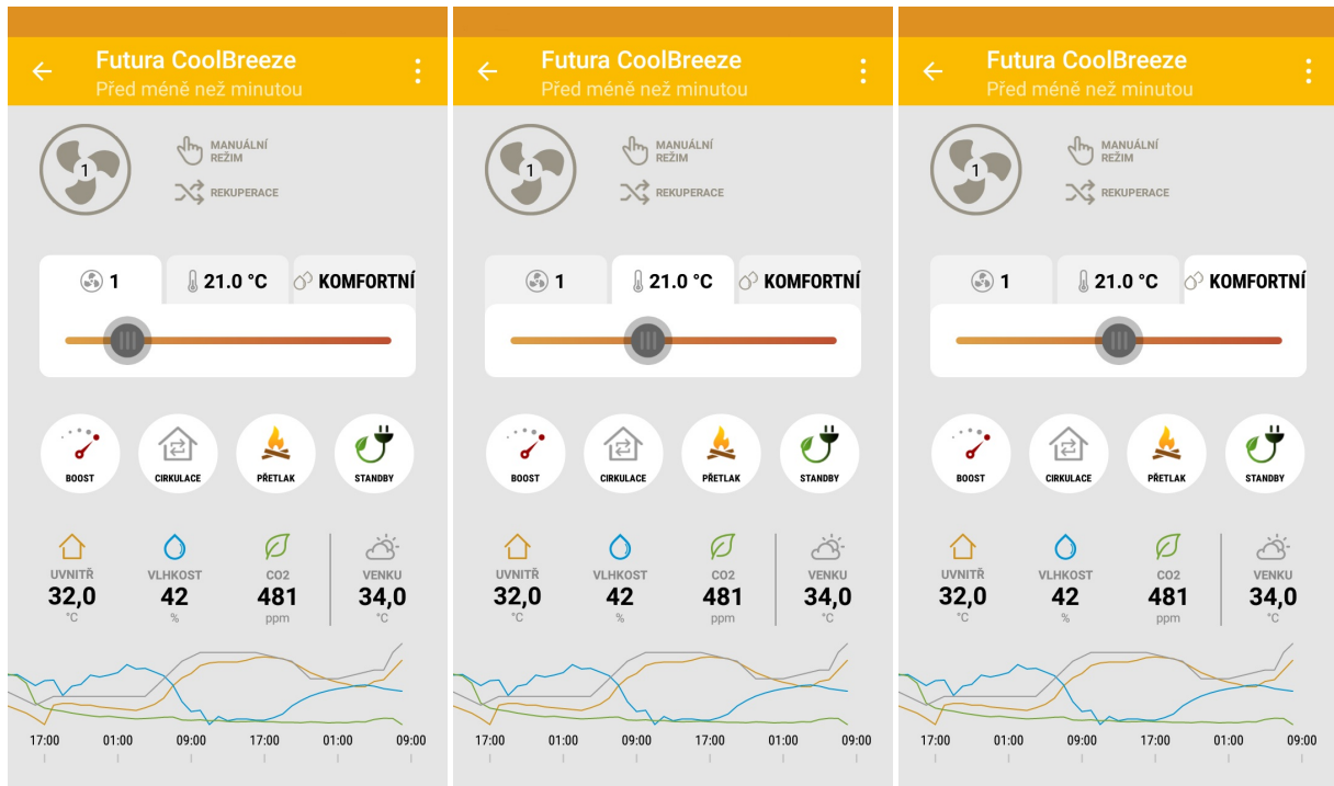
Obrázek 19 – Nastavení výkonu ventilátorů; Obrázek 20 – Nastavení teploty; Obrázek 21 – Nastavení vlhkosti
